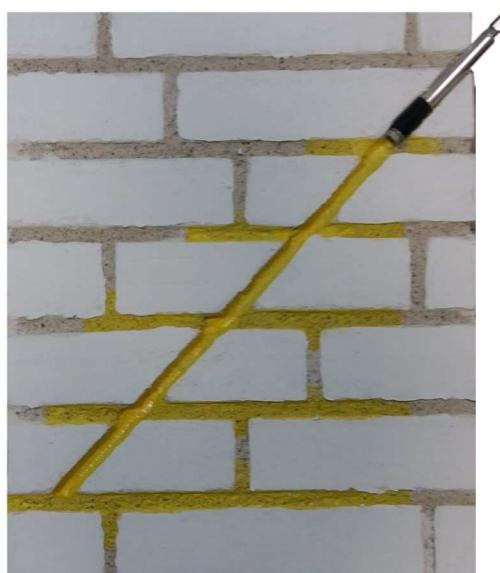
БИРСС Грунт Гидростоп на основе эфира кремниевой кислоты ( $\text{Si}(\text{OR})_4$ ) при взаимодействии с водой выделяет диоксид кремния ( $\text{SiO}_2 \cdot \text{aq}$ ) в качестве вяжущего:
