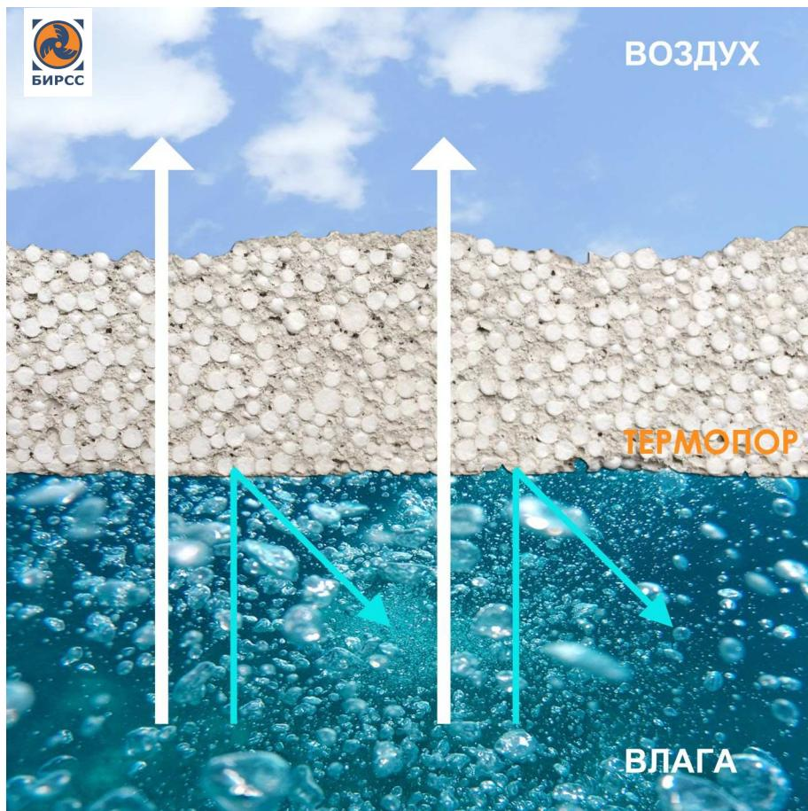
В результате объединения прочностных свойств цемента и теплоизолирующей способности полистирола помещение сохраняет способность дышать, а на поверхности утепленной стены не происходит конденсации бытовой влаги, так как пресловутая точка росы с внутренней поверхности стены уходит внутрь.
